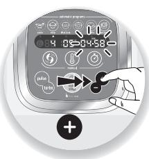
2- Ensuite réglez le(s) paramètre(s) à l'aide du sélecteur +/- (**B6**). Pour des raisons de sécurité, il n'est pas possible de régler une température sans régler un temps de cuisson.
