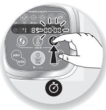
1- Drücken Sie auf die Auswahltaste der Einstellung, die Sie ändern möchten: den Geschwindigkeitsregler (**B2**) oder den Gartemperaturregler (**B3**) oder den Zeitregler (**B4**). Daraufhin blinkt der ausgewählte Parameter auf der Anzeige auf (**C1- C2-C3**).
