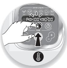
2- Les paramètres pré-programmés peuvent être modifiés le temps d'une recette (selon la recette choisie, les ingrédients, les quantités préparées). Appuyez sur le sélecteur vitesse (**B2**) ou le sélecteur température de cuisson (**B3**) ou le sélecteur temps (**B4**), le paramètre choisi clignote à l'écran (**C1-C2-C3**).
